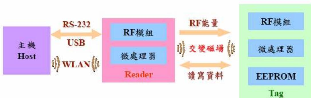
圖 2-3 RFID 動作原理
