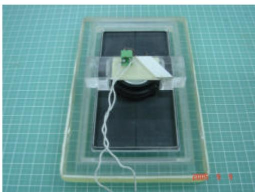
圖(十二)、製作好的奈米碳管加勁複合材料揚聲板試件
