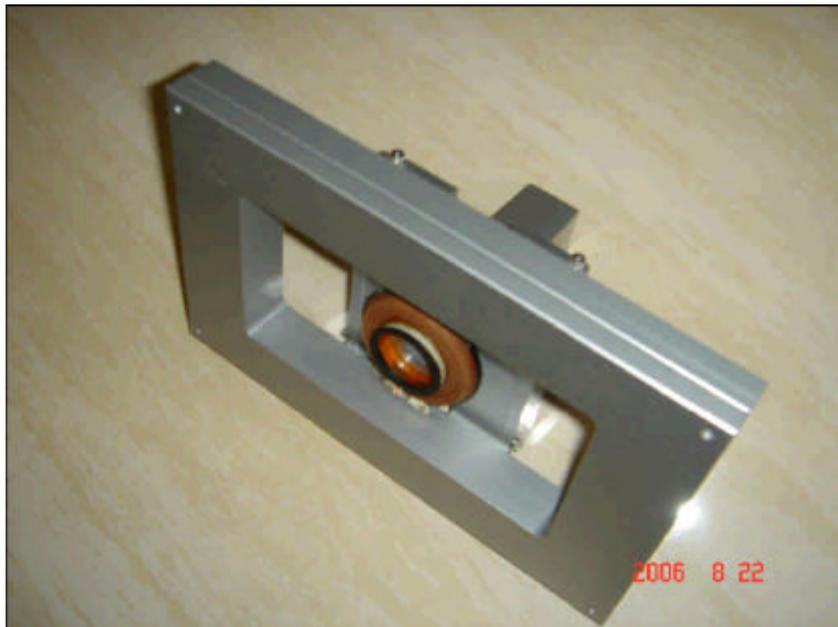
圖(十四)、改良式聲壓實驗設備機構後等角視圖
