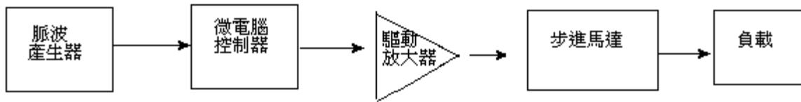
圖 1-2 步進馬達控制流程圖[11]
