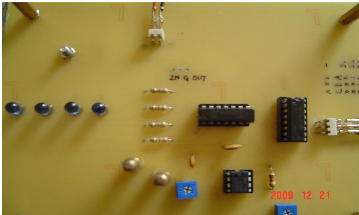
圖 3-19 紅外線發射電路
