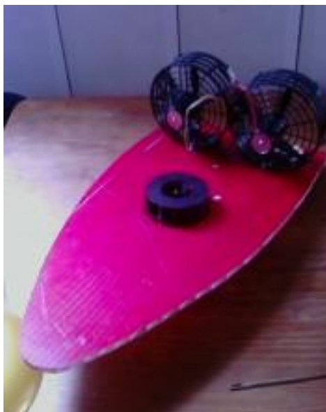
圖 16 裝上推力與轉向的電風扇圖片
