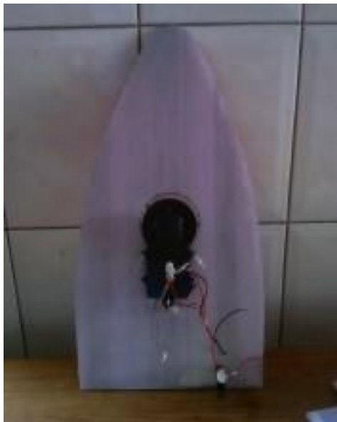
圖 12 在做出的圓上面裝上向下出力電風扇
