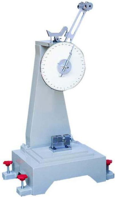
圖 4-1-4 耐衝擊試驗機
