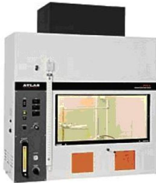
圖 4-1-22 水平垂直燃燒試驗機
