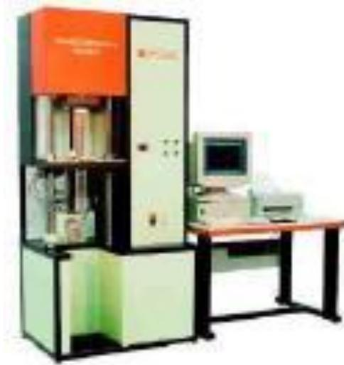
圖 4-1-1 毛細管流變儀
