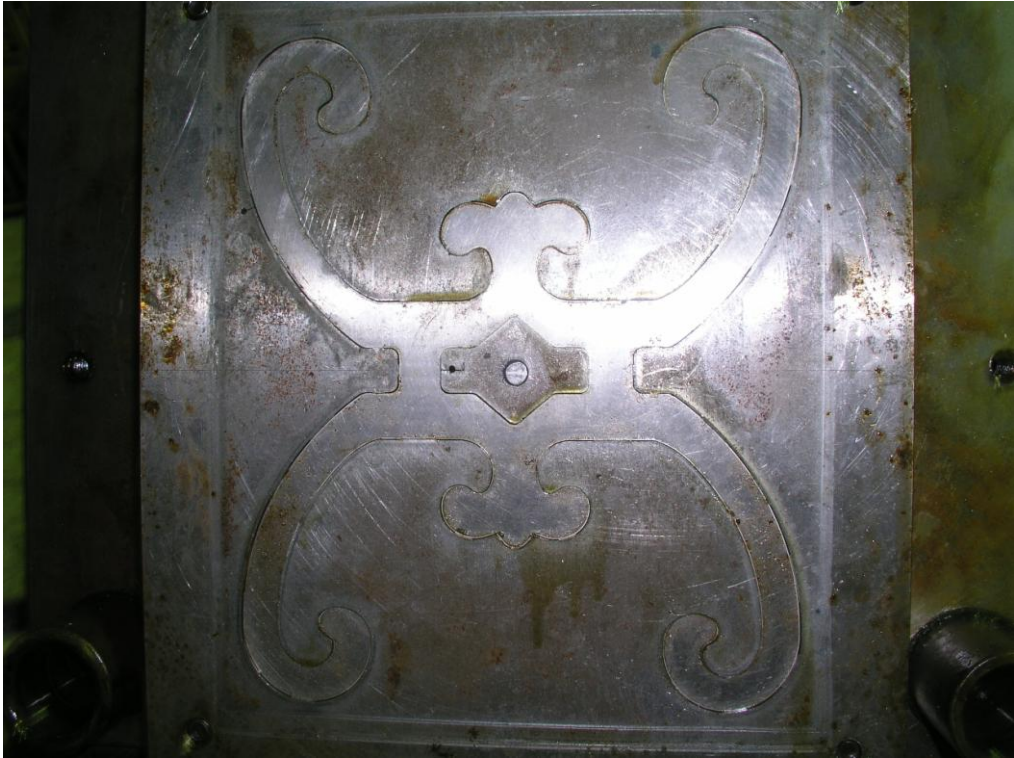
圖 3-16a 衝頭固定板之模具實體圖
