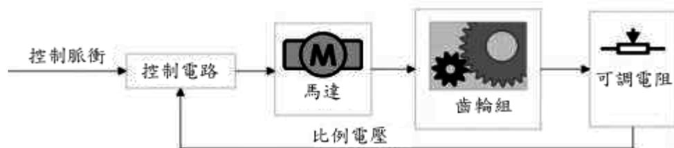
減速齒輪組由馬達驅動，其終端（輸出端）帶動一個線性的比例電阻作位置檢測，該電阻把轉角坐標轉換為一比例電壓反饋給控制線路板，控制線路板將其與輸入的控制脈衝信號比較，產生糾正脈衝，並驅動馬達正向或反向地轉動，使齒輪組的輸出位置與期望值相符，令糾正脈衝趨於為 0，從而達到使伺服馬達精確定位的目的。
