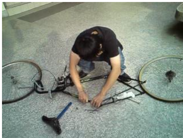
安裝車架 上管鎖緊 ↑
