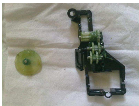
圖 4.5 主軸齒輪盒分解圖
