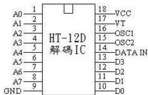
圖 10. HT-12D 解碼 IC 腳位圖
