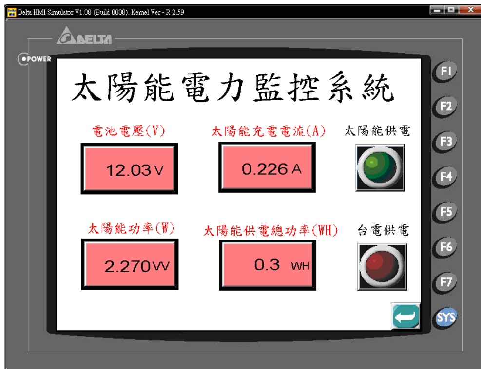
圖十三 太陽能電力監控系統圖控介面
