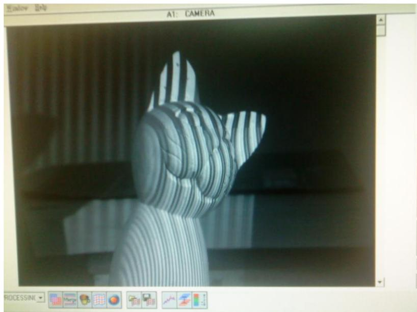
圖 4-4 進行光線明亮度調整，完成後按 OK 進行雷射掃瞄拍照。
