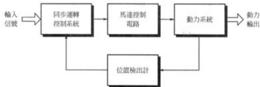
圖 2-4 伺服馬達控制電路方塊圖
