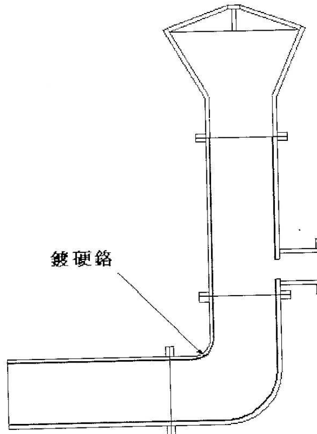
圖 5-1：RC 泵的正視圖，紅色部分為鍍硬鉻的地方
