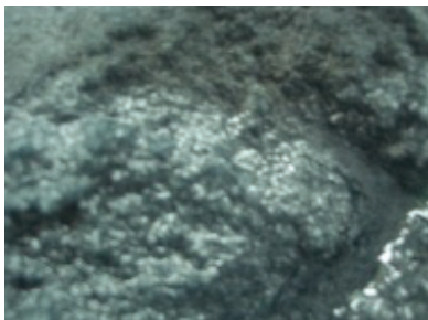
(c) 不鏽鋼奈米磨粒(200µm+樹脂)
