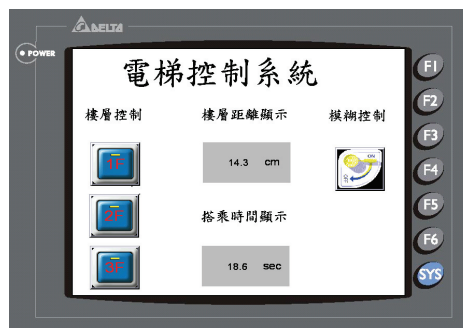
圖十三：電梯控制系統之控制視窗圖
