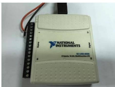
圖3-18 NI USB-6009 DAQ資料擷取卡
