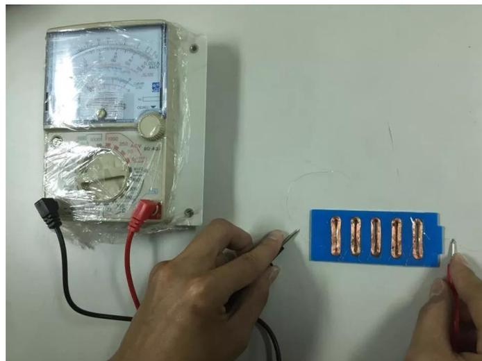
圖4-10 以三用電錶量測片體之線圈
