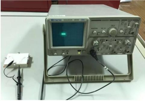
圖 3-13 探測棒連接發電機
