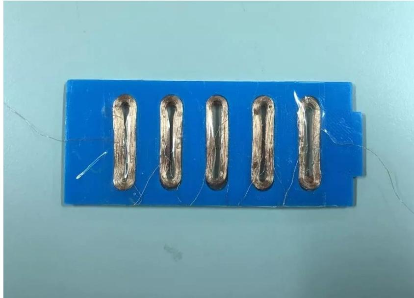
圖4-9 頭尾相連之線圈固定於片體線圈槽中
