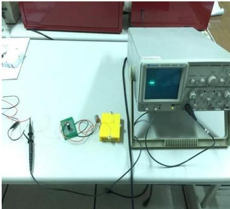
圖 3-15 發電機與橋式整流電路連接
