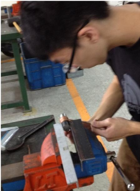
圖 3.28 製作管徑 3mm 圈數 6 鍋爐
