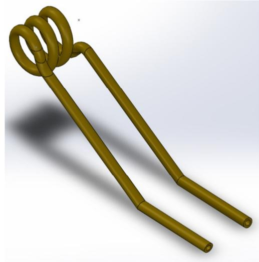
圖 3.9 鍋爐管徑 5mm 圈數 3
