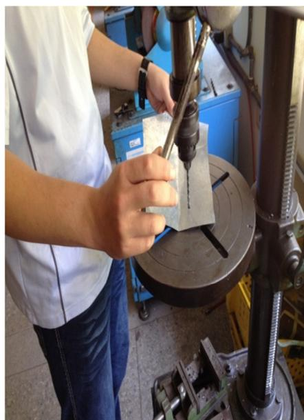
圖 3.33 鑽孔  $\varnothing 3.2\text{mm}$
