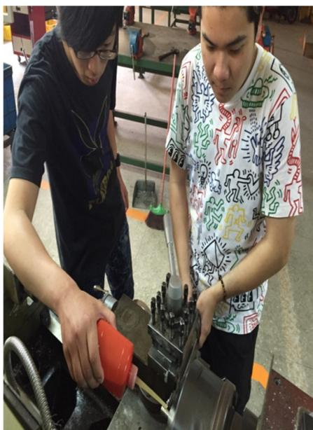
圖 3.34 軸套切凹槽
