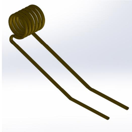
圖 3.6 鍋爐管徑 3mm 圈數 6
