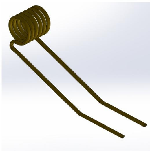
圖 3.15 鍋爐管徑 3mm 圈數 6
