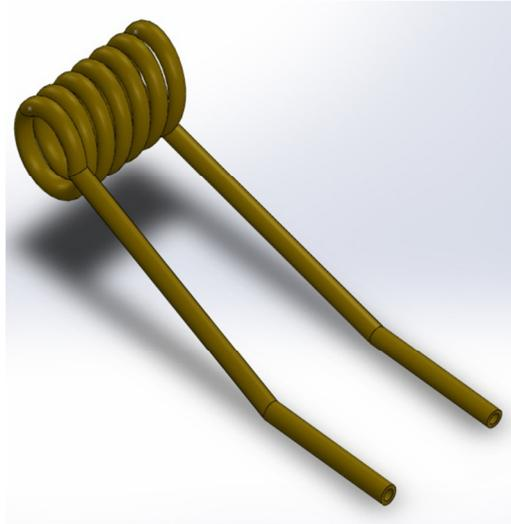
圖 3.11 鍋爐管徑 5mm 圈數 6
