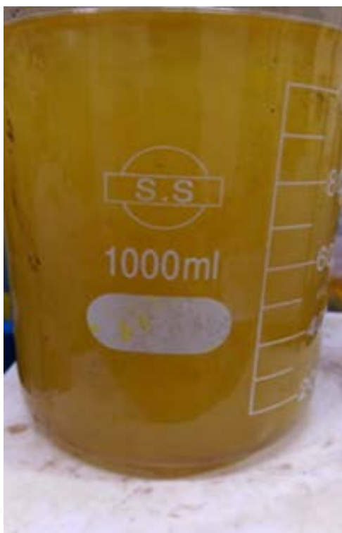
圖 7. 加入 2M KI 20mL 混合後以 \text{Na}_2\text{S}_2\text{O}_3 滴定至淺黃色
