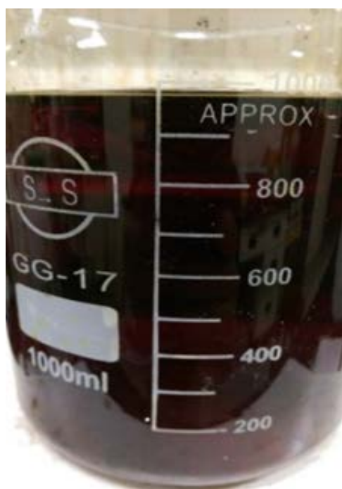
圖 6. 加入 4N 硫酸 100mL 和 0.1N \text{KMnO}_4 100mL 攪拌，與木質素反應
