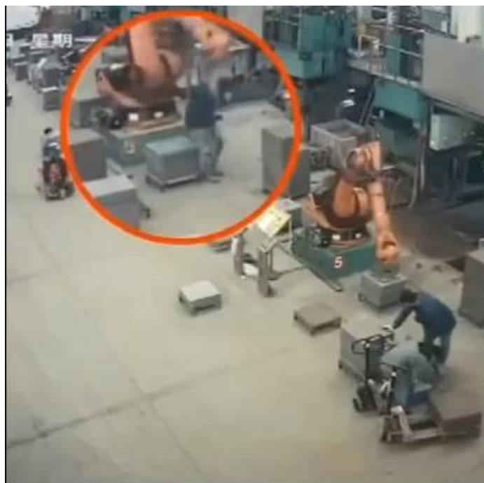
圖 1、工作人員太過靠近機械手臂(資料來源: bilibili)
